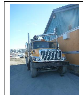
Camion remplissant sa citerne à l'usine de traitement d'eau via le bras de chargement
